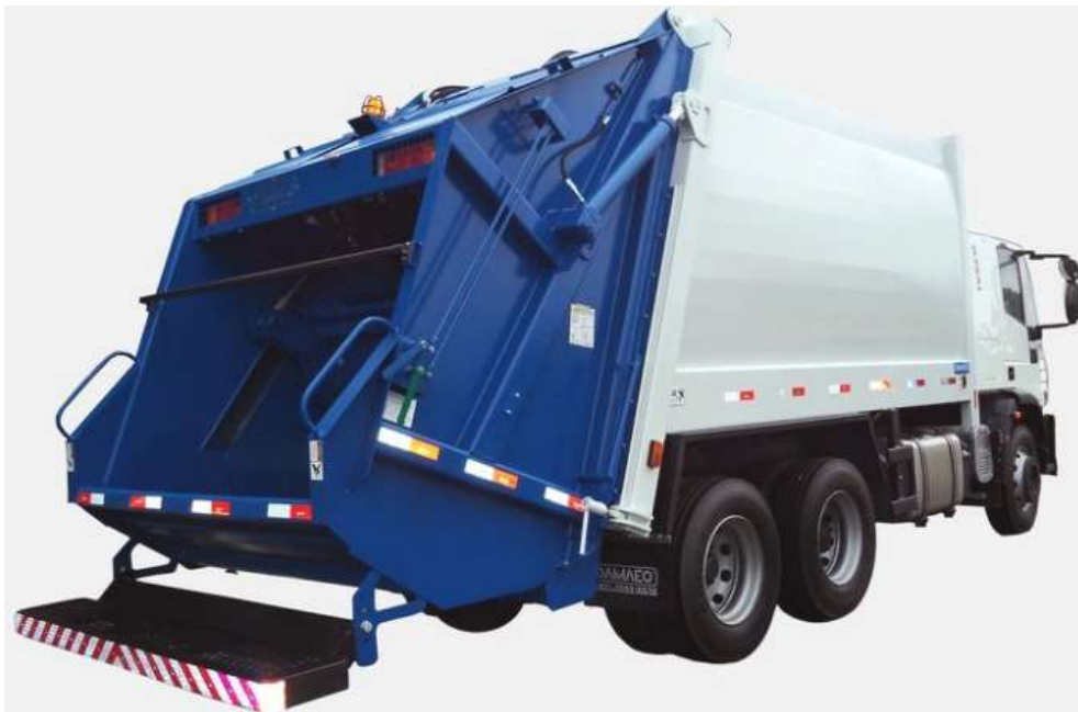
Figura 1 - Veículo compactador de carga traseira.
